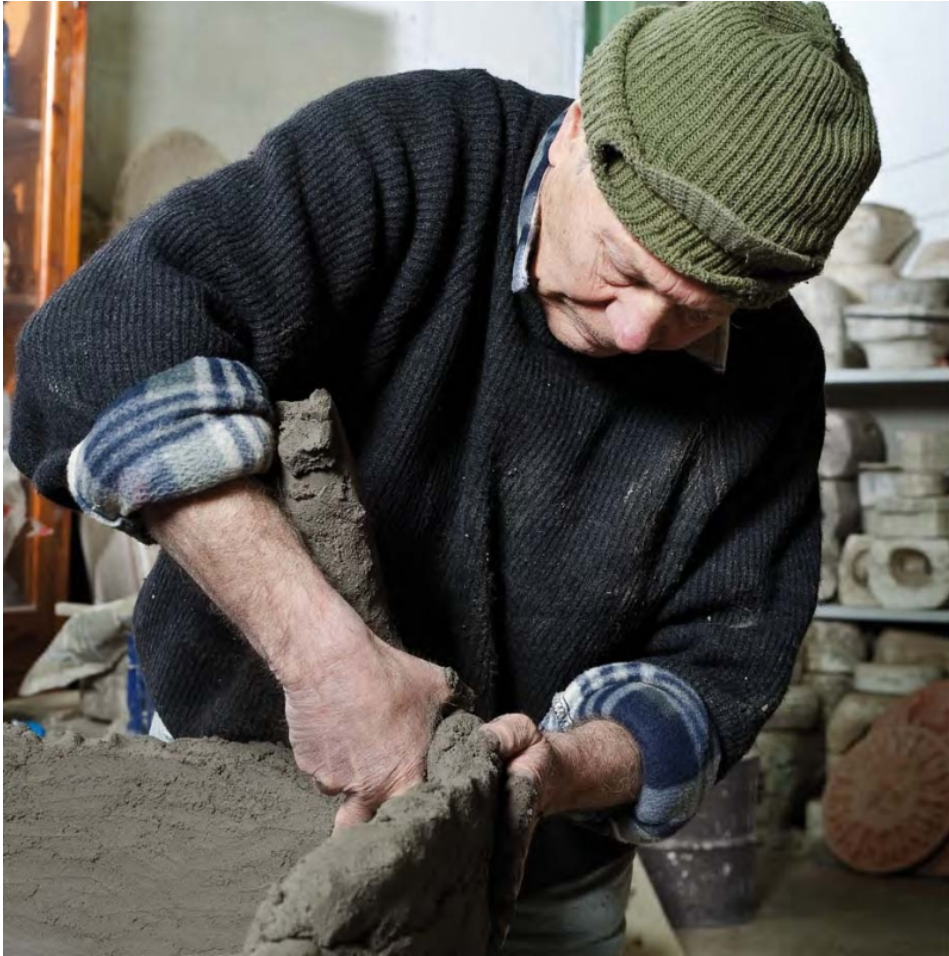
Photo n°11 : Dans l'atelier Artenova la fabrication des jarres est réalisée de manière traditionnelle selon la technique du montage au colombin. © Artenova .
