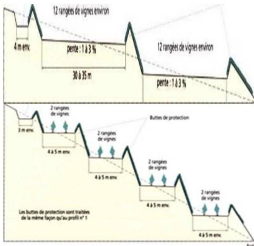
Figure 4. Exemple d'aménagement à Beaumes-de-Venise, 1<sup>ère</sup> figure : banquette large, 2<sup>ème</sup> figure : banquette, C. Milhaud, Aménagement et nature n°141, 2001.
