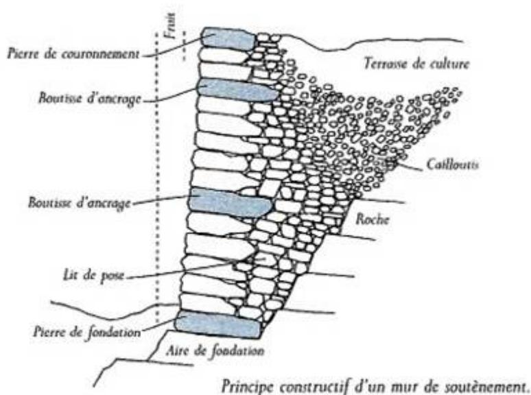
**Figure 2. Coupe schématique d'un mur de soutènement, éléments de construction, extrait de « La pierre sèche, mode d'emploi » par Christian Lassure, éditions Eyrolles, 2014.**
